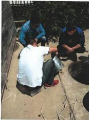
图三 废水总排口监取样照片
