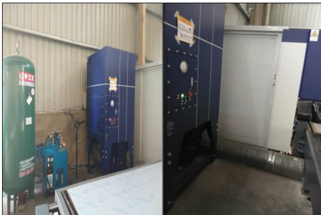
图 4.1-3 沉流式滤筒一体化除尘器
