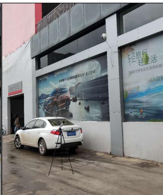
图 2 厂界噪声监测现场照片
