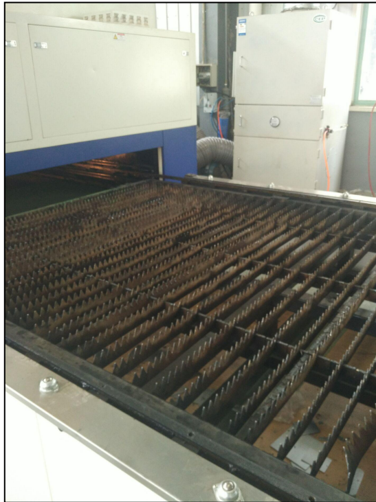
图 4.1-10 激光切割机及脉冲除尘器照片
