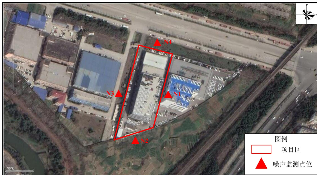
图 7.1-4 项目噪声监测点位示意图
