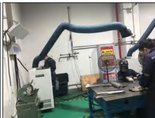
图 4.1-9 移动式焊接烟尘净化器
