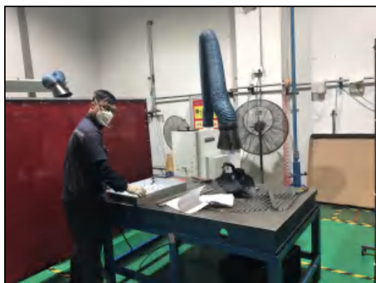
图 4.1-8 移动式焊接烟尘净化器
