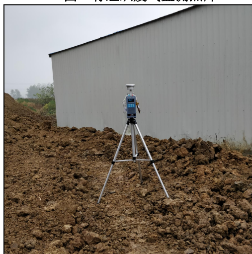
图4 无组织废气监测照片
