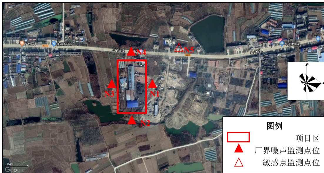
图 7.1-4: 厂界和敏感点处噪声监测点位示意图
