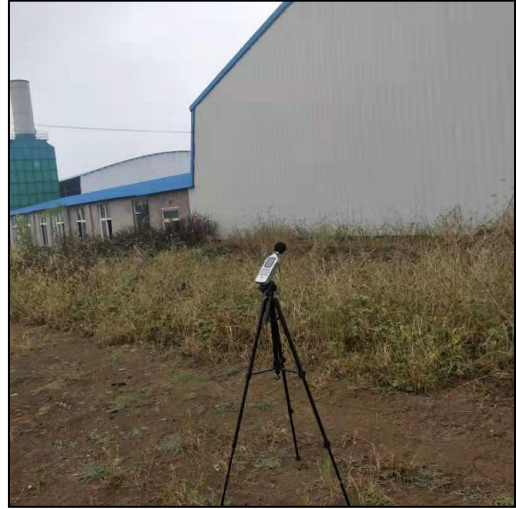
图8 厂界噪声监测照片
