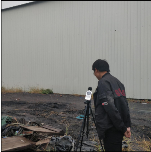
图7 厂界噪声监测照片
