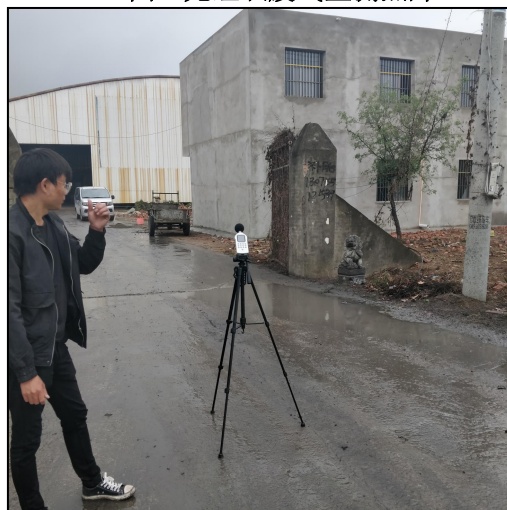
图6 厂界噪声监测照片
