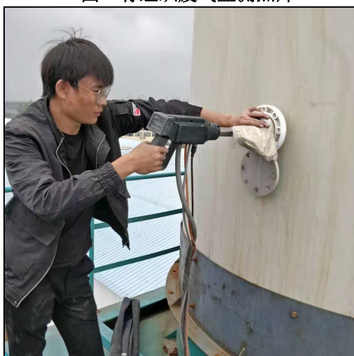
图3 有组织废气监测照片
