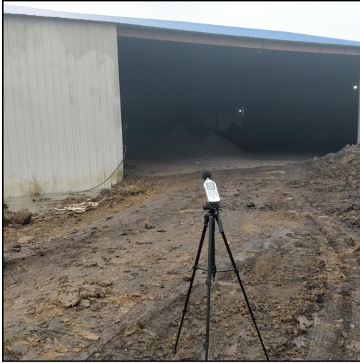
图7 厂界噪声监测照片
