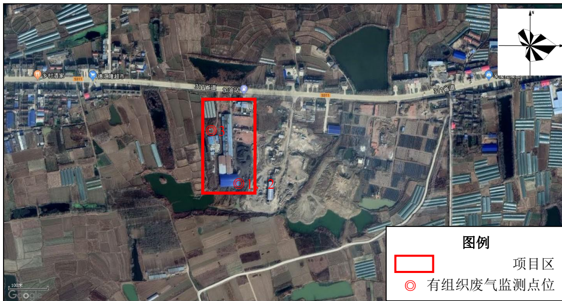
图 7.1-2：项目有组织废气监测点位示意图
