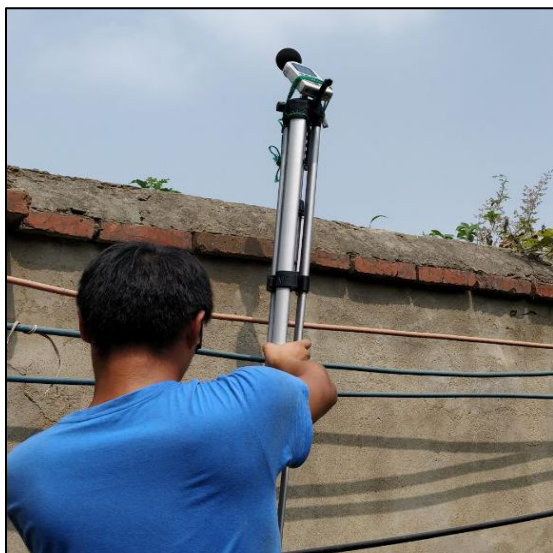
图 3 厂界噪声监测现场照片
