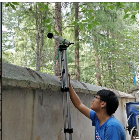
图 4 厂界噪声监测现场照片
