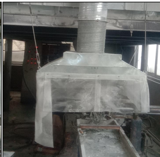
图 4-14 收集装置（集气罩+软帘）
