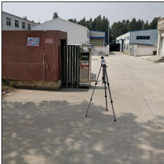
图 1 厂界噪声监测现场照片
