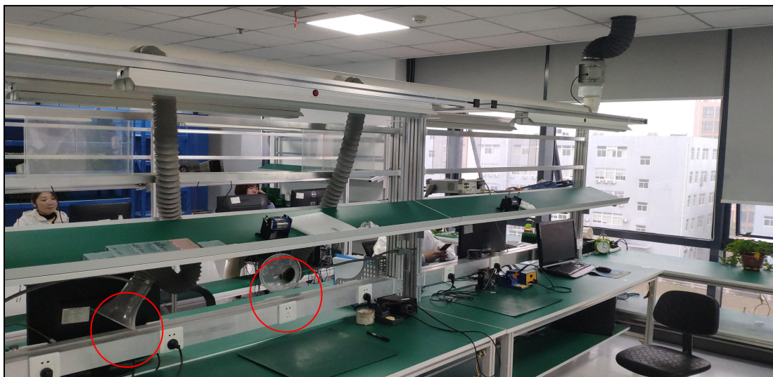
图 4.1-6 点焊工位集气罩照片
