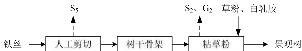
图 3.6-4 景观树生产工艺流程及产污节点图
