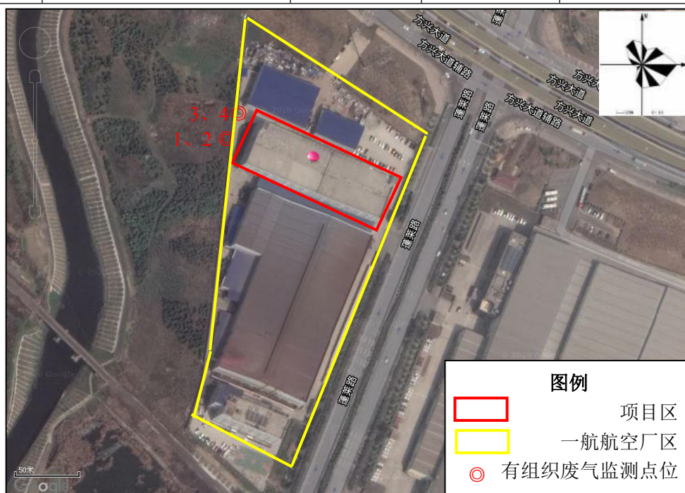
图 7.1-2：项目有组织废气监测点位示意图
