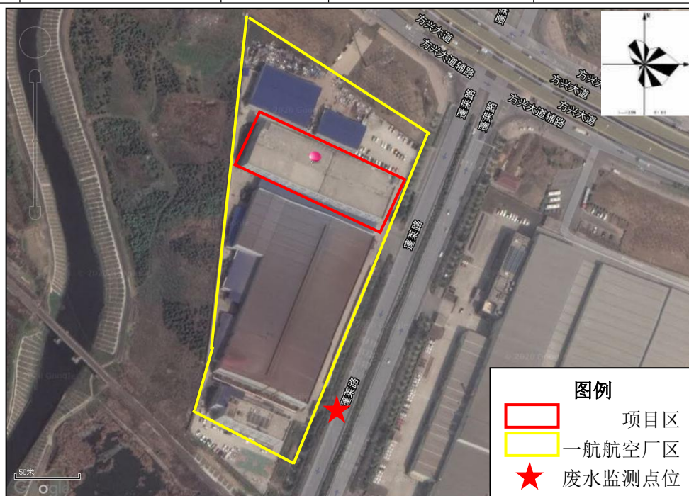
图 7.1-1：项目废水监测点位示意图
