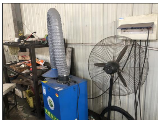
图 4.1-3 移动式焊接烟尘净化器
