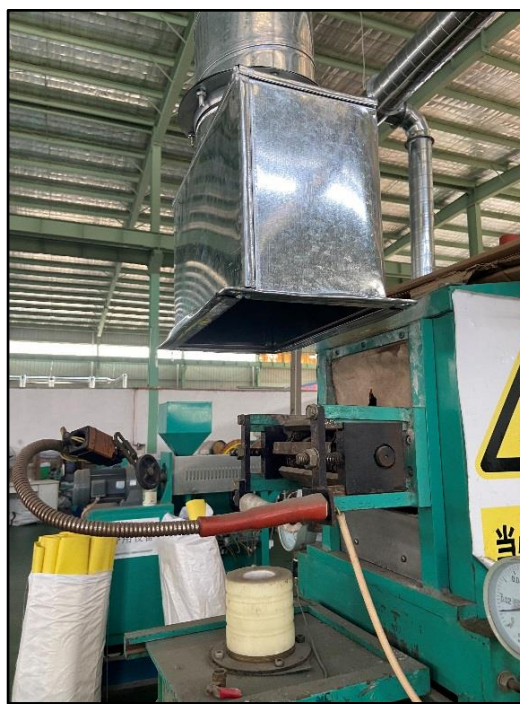
图 4.1-10 热扩机集气罩
