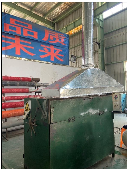
图 4.1-9 热扩机集气罩
