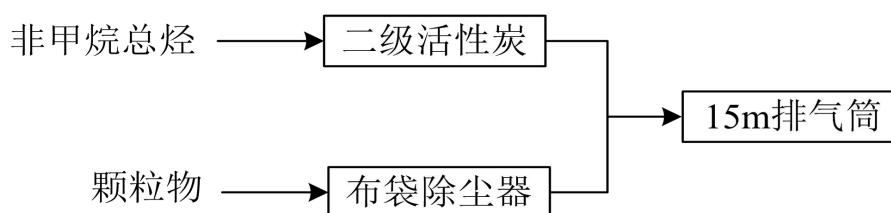
图 4.1-4 废气处理工艺流程图
