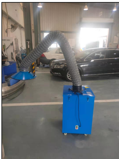
图 4.1-17 移动式焊接烟尘净化器
