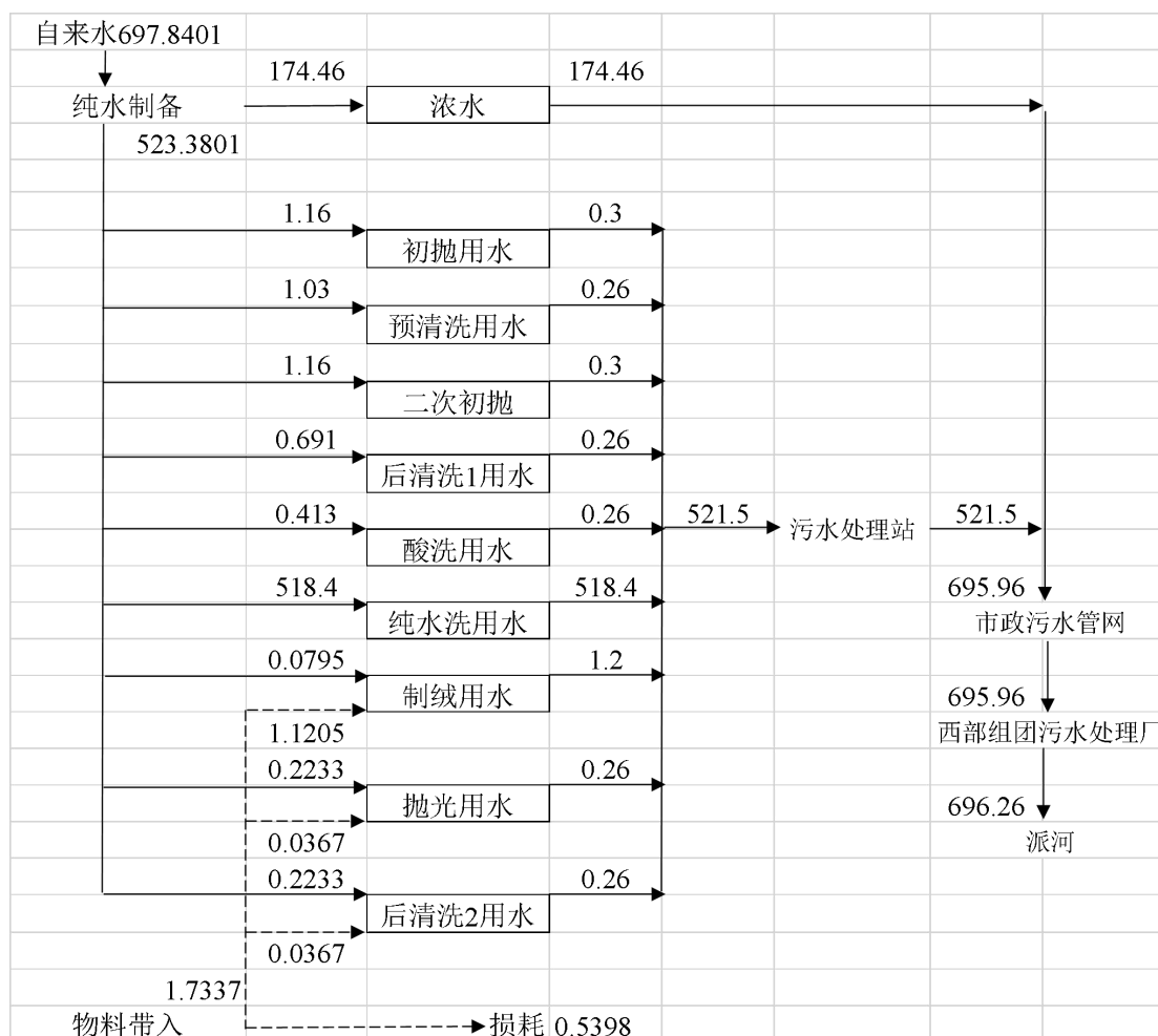
图 3.5-1 本扩建项目实际水平衡图 单位：t/d
