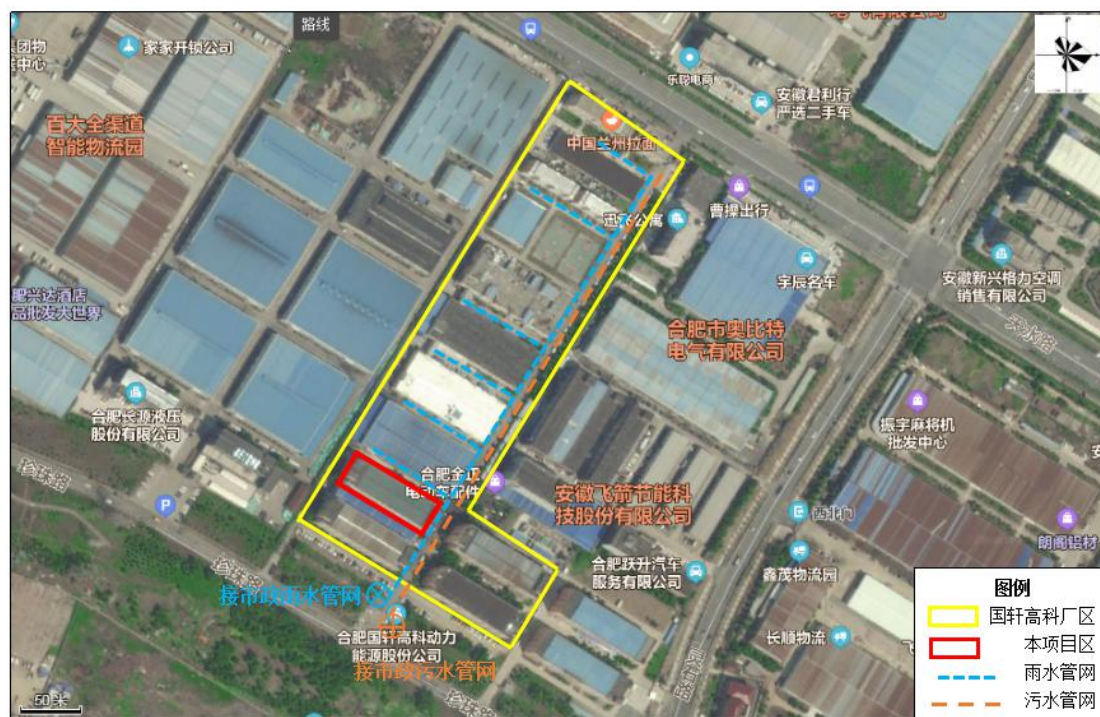
图 4.1-1 厂区雨污水管网图
