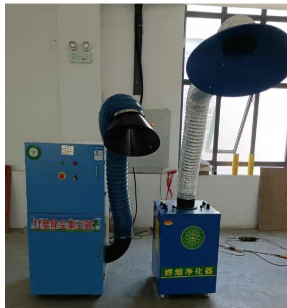
图 4.1-7 移动式焊接烟尘净化器和打磨除尘集尘器
