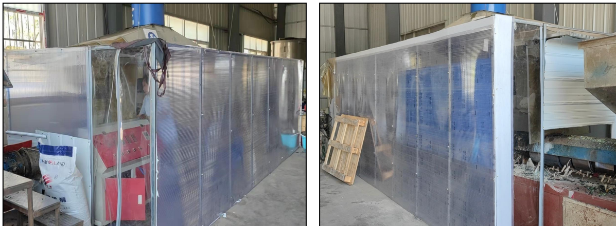
图 4.1-4 挤出机集气罩
