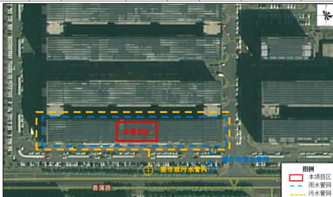
图 4.1-1 雨污水管网图
