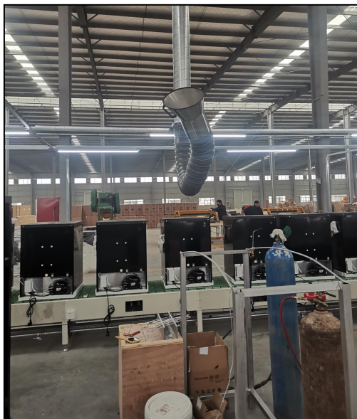
图 4.1-7 装配工序集气罩
