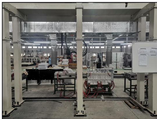
图 4.1-6 发泡工序集气罩
