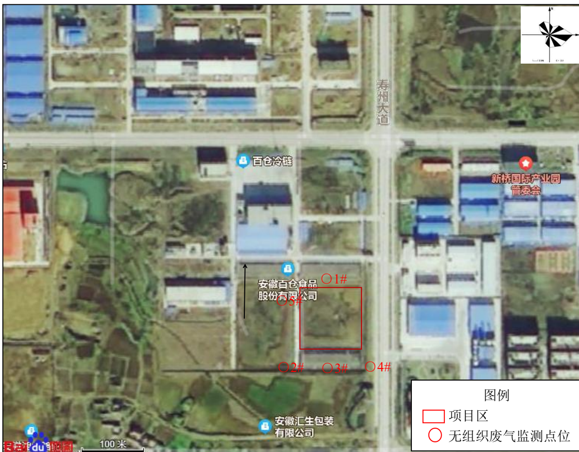
图 7.1-2：项目无组织废气监测点位示意图（两天风向相同，北风）
