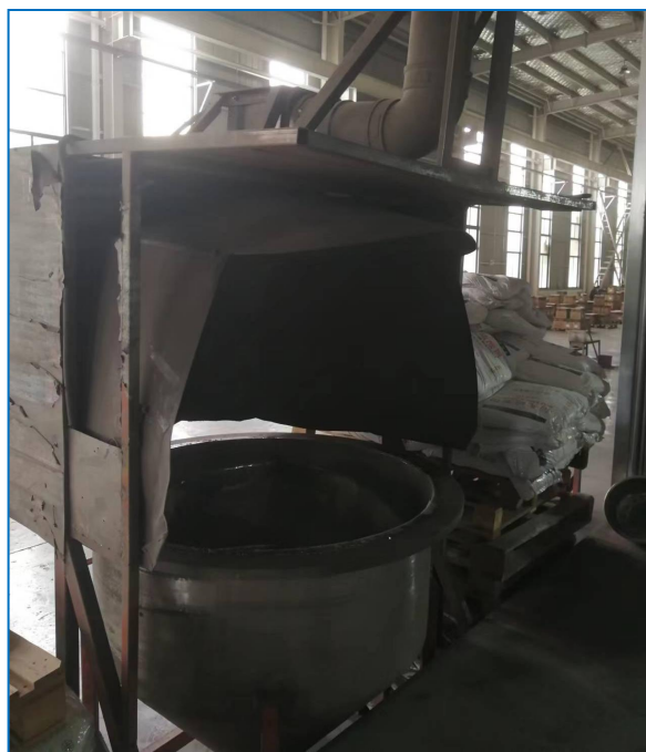
图 4.1-5 投料工序集气罩
