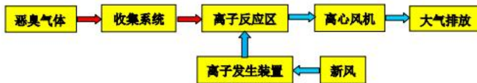
图 4-37 离子除臭装置工艺流程图
