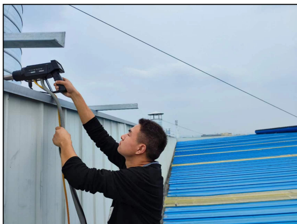
图 5-9 有组织废气监测照片 (DA003 排气筒出口)
