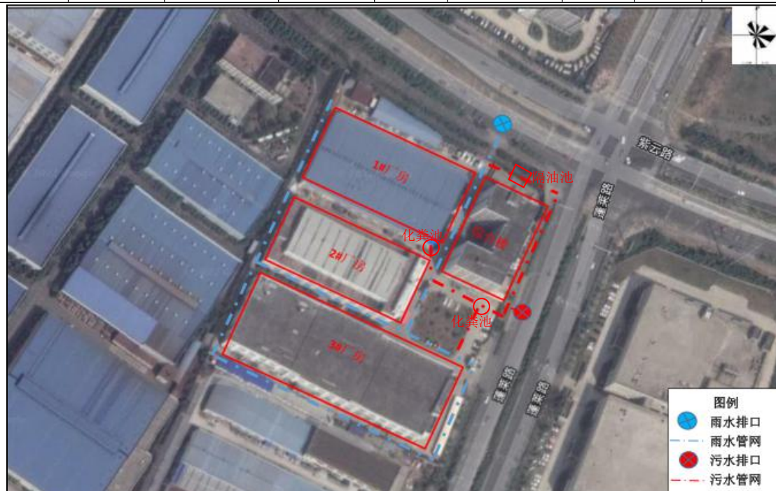
图 4.1-1 雨污水管网图
