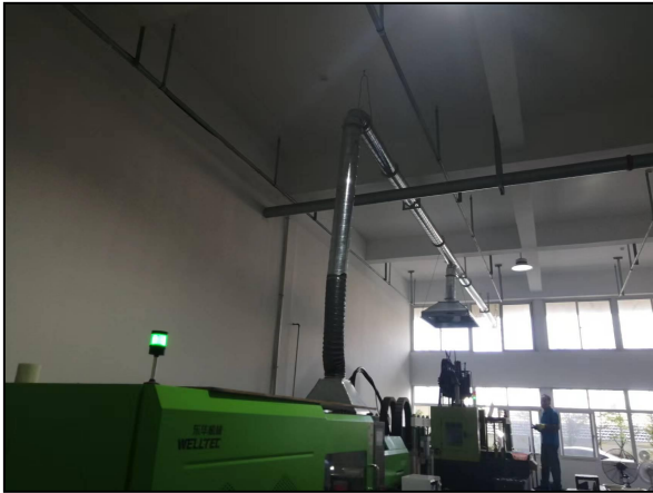
图 4.1-5 液体胶立式、液体胶卧式机集气罩
