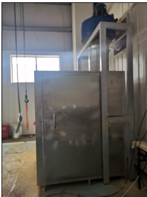
图 4.1-4 过滤+二级活性炭吸附装置一体机
