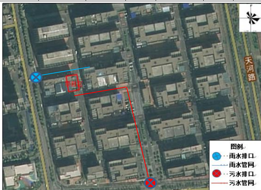
图 4.1-1 雨污水管网图
