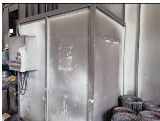
图 4.1-5 自带单级滤芯回收装置
