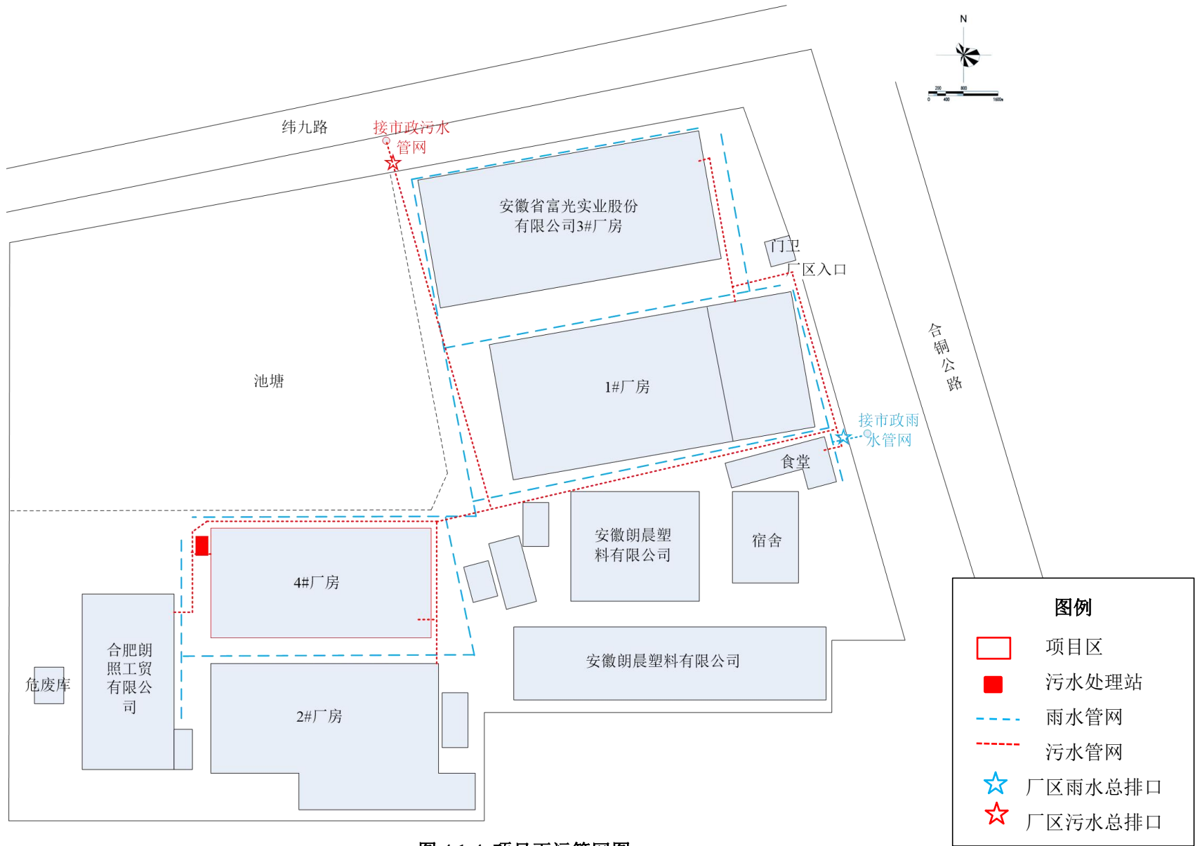
图 4.1-4 项目雨污管网图
