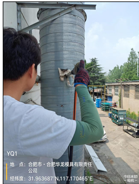
图 4-4 有组织废气监测照片 (DA001 排气筒出口)
