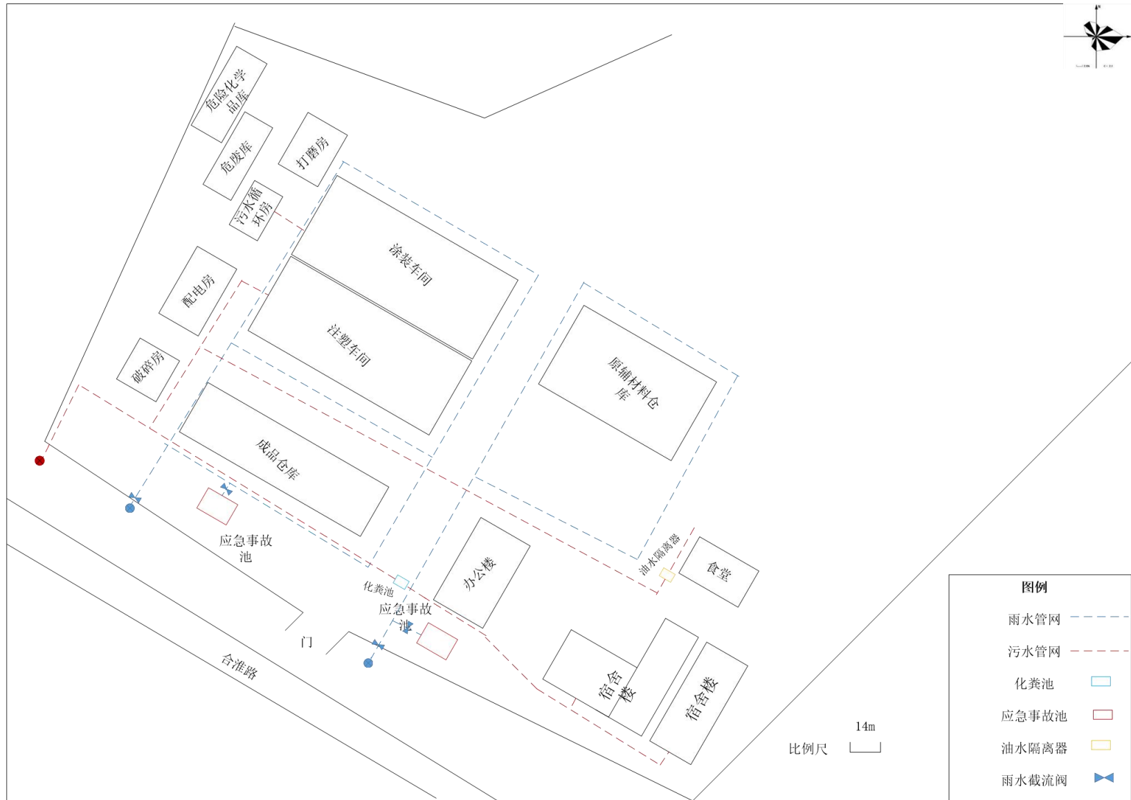
图 4.1-1 厂区雨污水管网图
