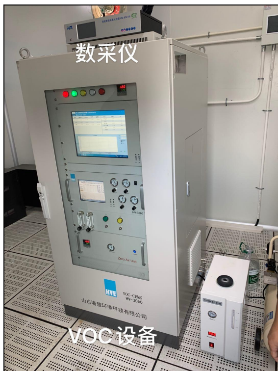
图 4.1-41 VOCs 在线监测装置
