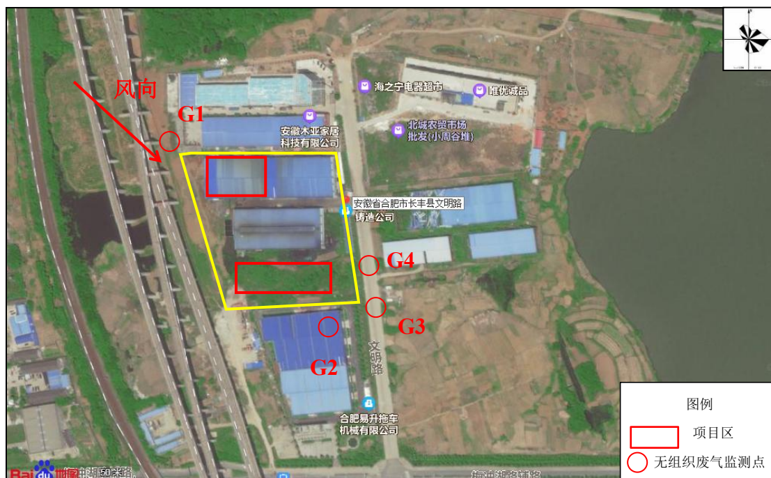
图 7.1-4 无组织废气监测点位示意图 (2月8日, 西北风)
