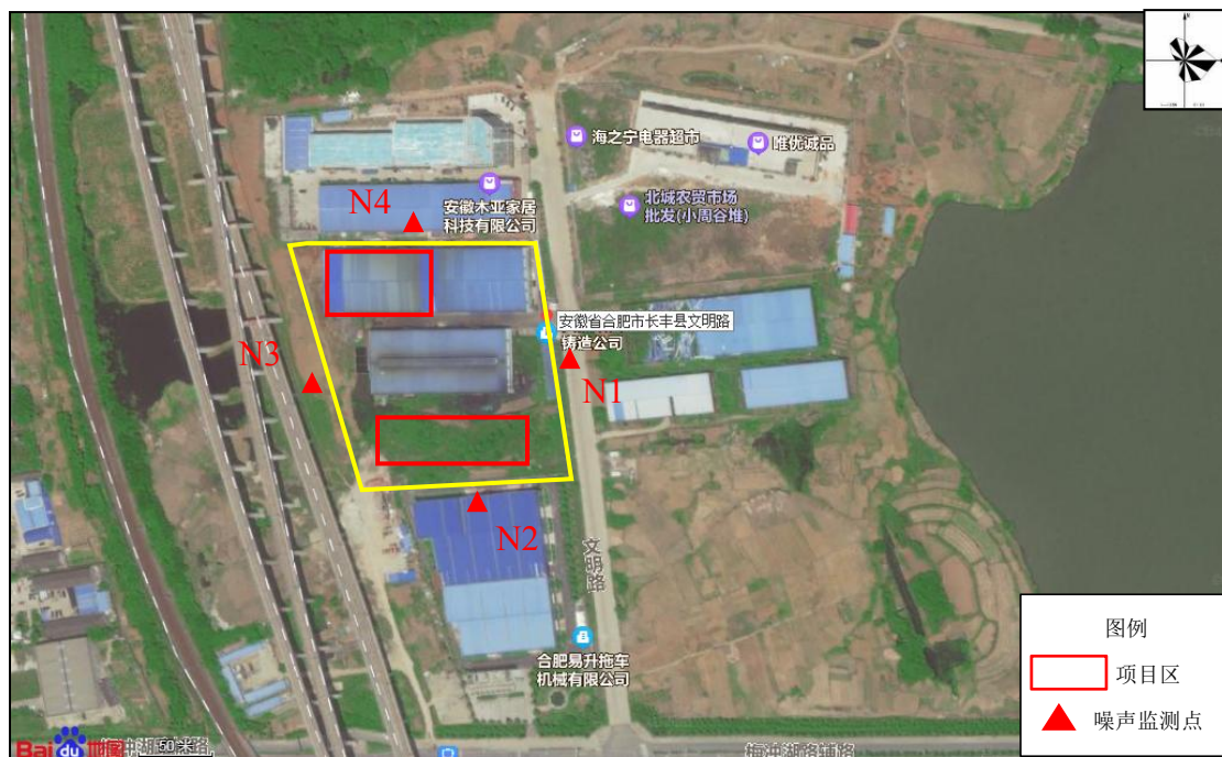
图 7.1-5 噪声监测点位示意图 (2月7日、2月8日)
