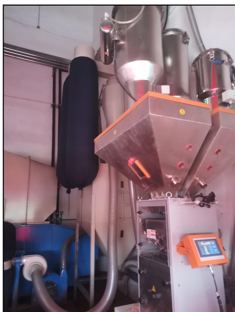
图 4.1-6 破碎机自带除尘设备
