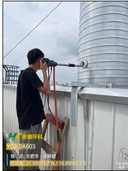
图 3-6 有组织废气监测照片 (DA003 排气筒出口)
