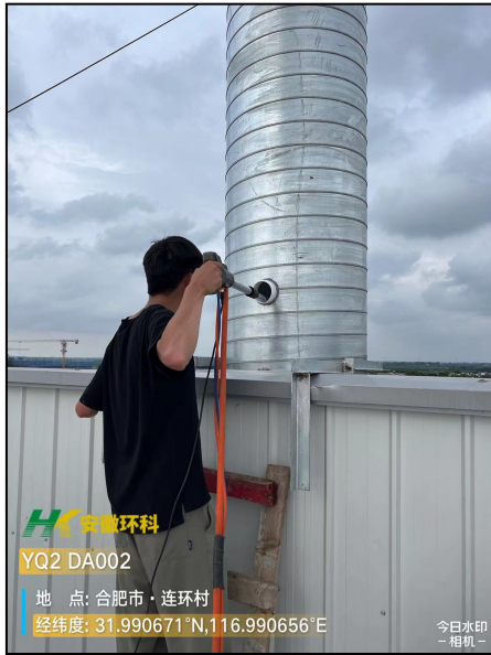
图 3-5 有组织废气监测照片 (DA002 排气筒出口)
