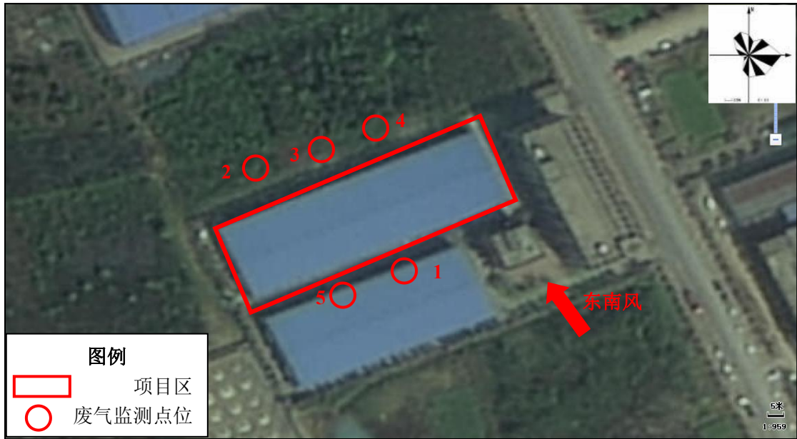
图 7.1-3 无组织废气监测点位示意图（监测时间 2023.8.11~8.12）（两天均为东南风）
