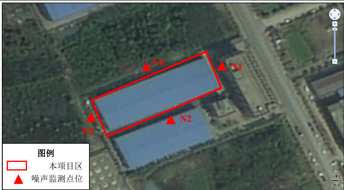
图 7.1-4 噪声监测点位示意图（监测时间 2023.8.11~8.12）
