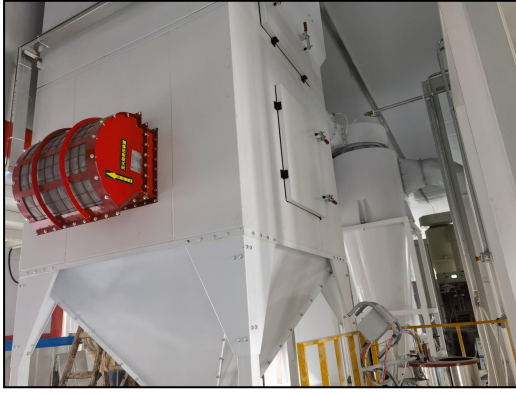
图 4.1-20 大旋风+滤筒除尘装置 (TA005)
