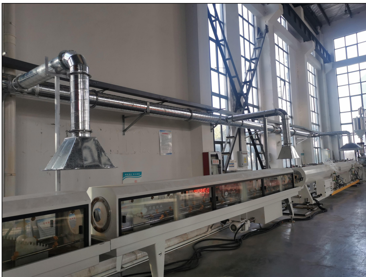
图 4.1-4 集气罩（挤出机、真空定型机上方）
