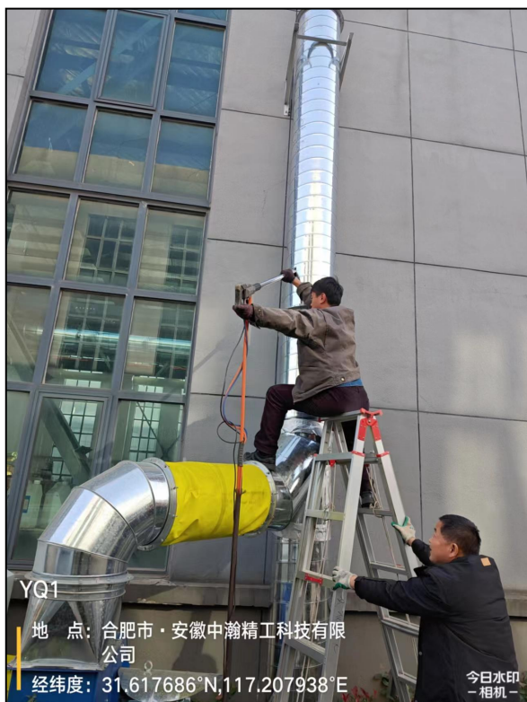
图 5-3 有组织废气监测照片（DA001 排气筒出口）
