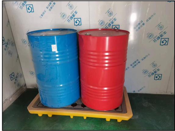
4.1-8 危废库防腐防渗、防泄漏托盘
