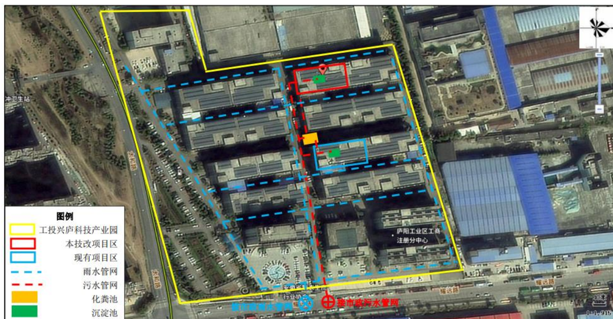
图 4.1-2 厂区雨污水管网图
