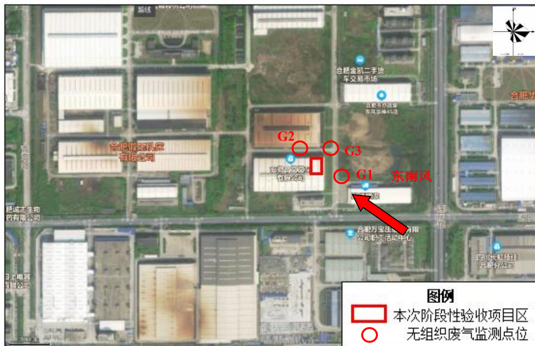
图 7.1-3 项目无组织废气监测点位示意图（监测时间 2024.1.8）
