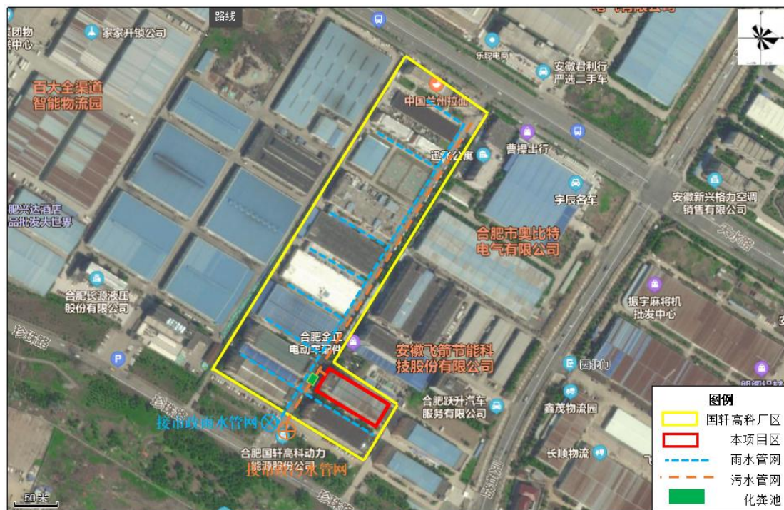
图 4.1-1 厂区雨污水管网图
