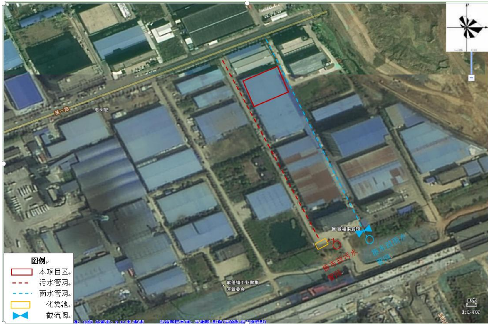
图 4.1-1 厂区雨污水管网图
