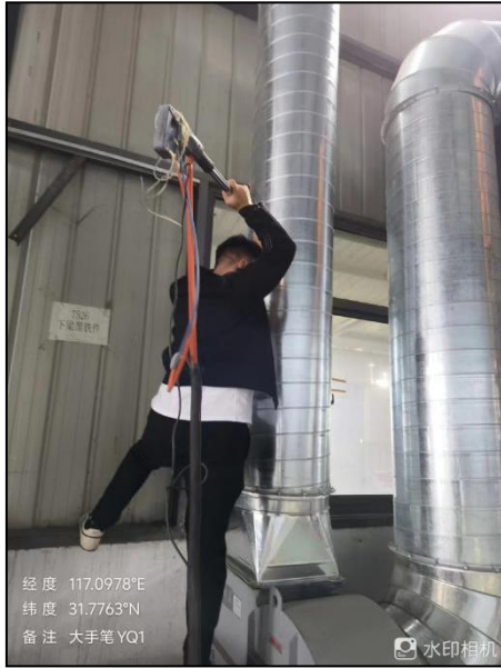
图 4-1 有组织废气监测照片 (DA001 排气筒出口)
