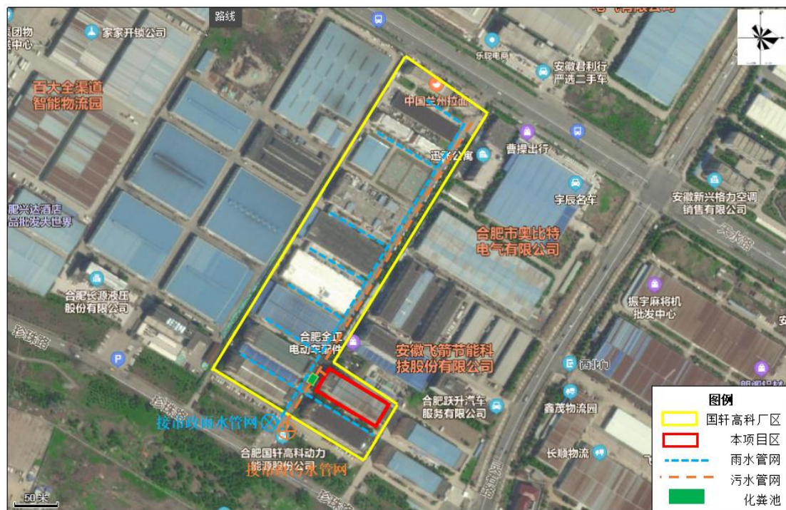
图 4.1-1 厂区雨污水管网图
