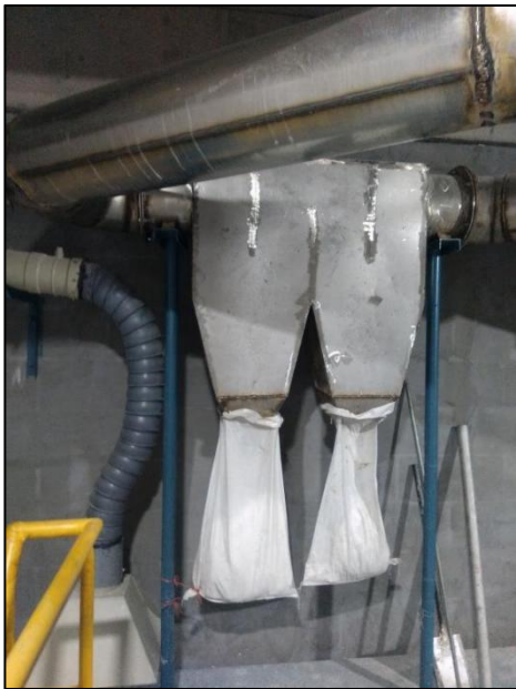
图 4.1-10 切片废气处理装置（重力除尘器）
