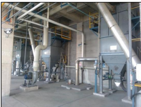
图 4.1-12 切片废气处理装置（布袋除尘器）
